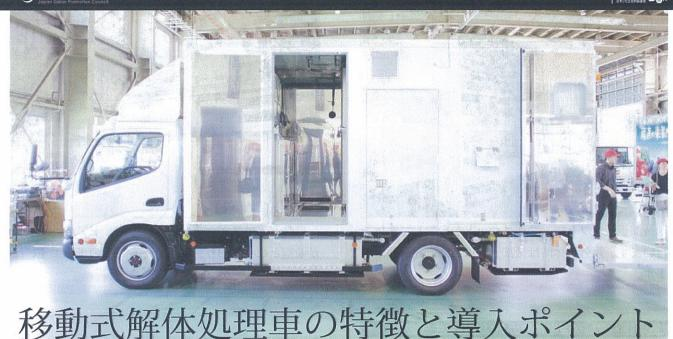
「移動式解体処理車」は、捕獲現場の近くまで移動し、内蔵摘出、剥皮から枝肉にするまでの一次処理を、 車内で迅速かつコンパクトに完結させることができる特装車です。日本ジビエ振興協議会、長野トヨ タ自動車(株)による共同開発で、今回の試作車第1号が完成しました。
