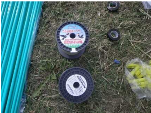
防除資材（つや消しされたステンレス線）線径0.3mmと3mの弾性ポール
