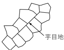
図 2.36 芋目地の組積みの例（施工してはならない積み方）
