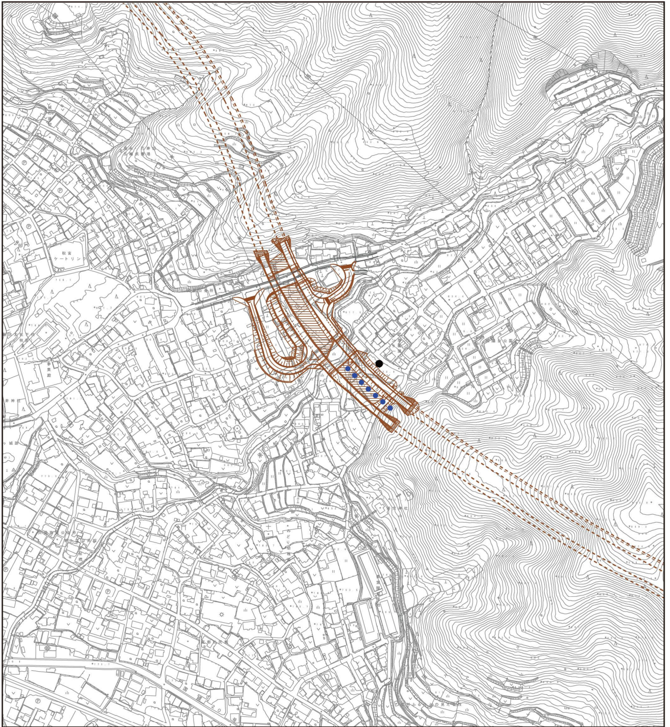
図 2.2.2 (12) 建設機械の稼働に係る大気質のユニット配置図 (12. 下諏訪町武居南 1)
