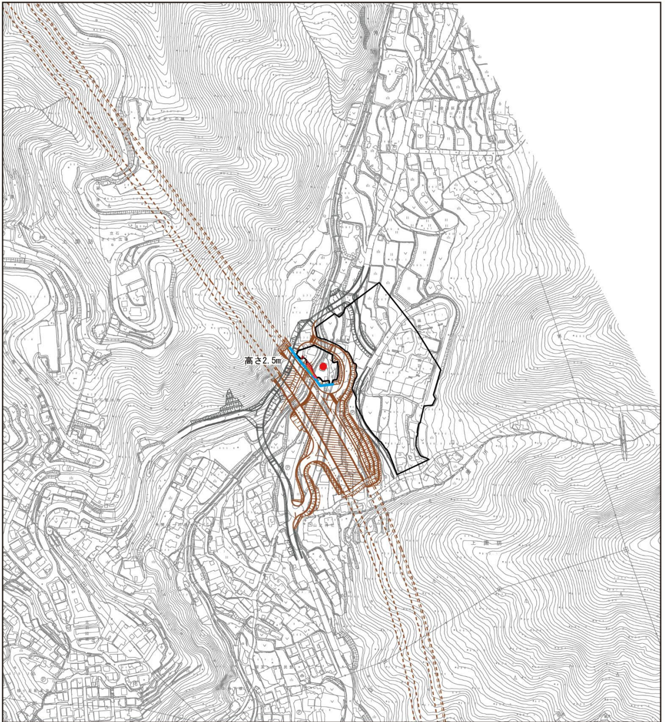
図 11.8.1.4 (3) 道路の存在に係る日照阻害の等時間日影図 (3. 諏訪市上諏訪)
