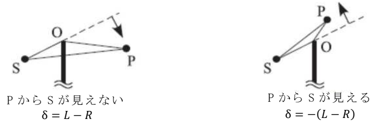
直達経路 R = SP 、回折経路 L = SO + OP 図 11.2.1.4 回折経路 \delta 差の定義
