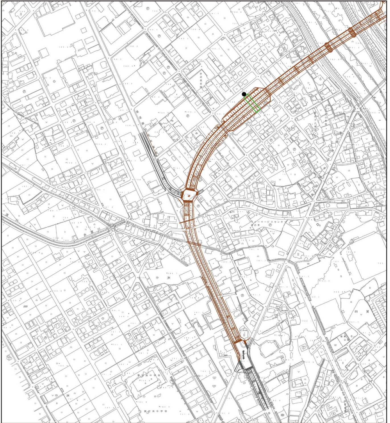
図 3.2.1 (2) 建設機械の稼働に係る騒音のユニット配置図 (2. 諏訪市四賀 2)
