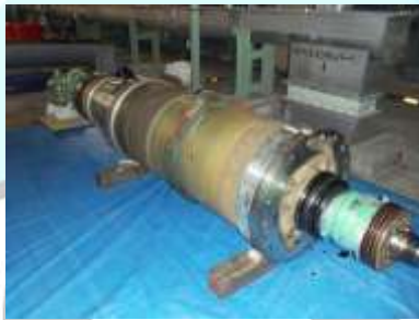
回転体外側（ボウル）の分解状況
