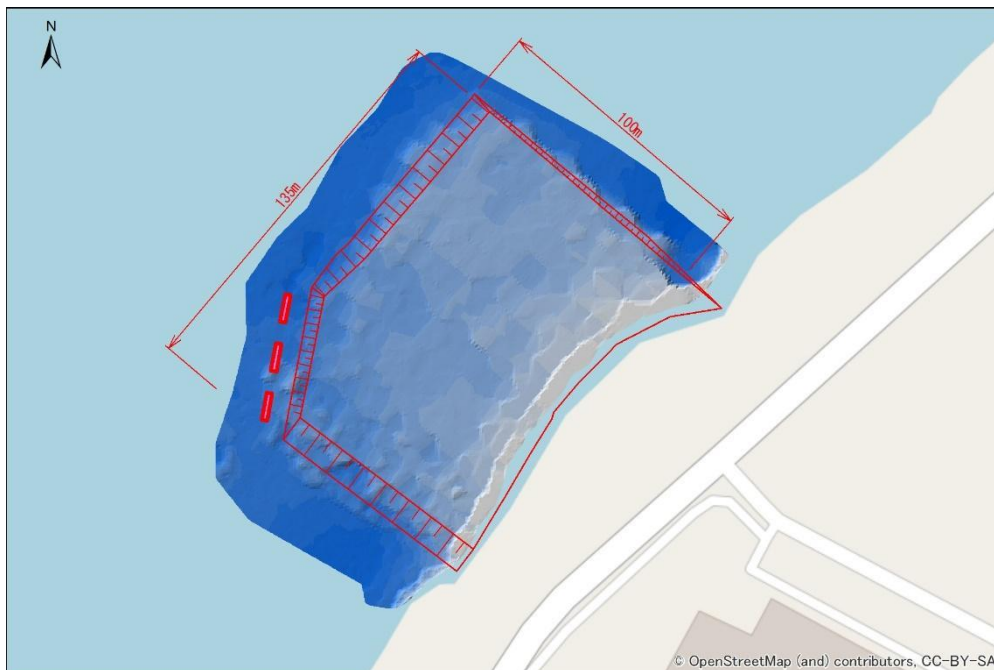
図 8 日赤沖 今回調査(H30.3.2)による 3D 地形図 (実線は完成時(H29.4月時点)の形状)
