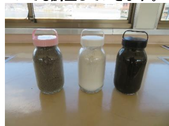
改良土← 改良剤+浚渫土
