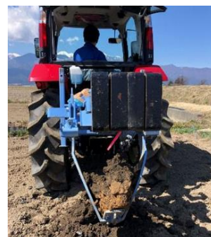
写真13 カットブレーカー
