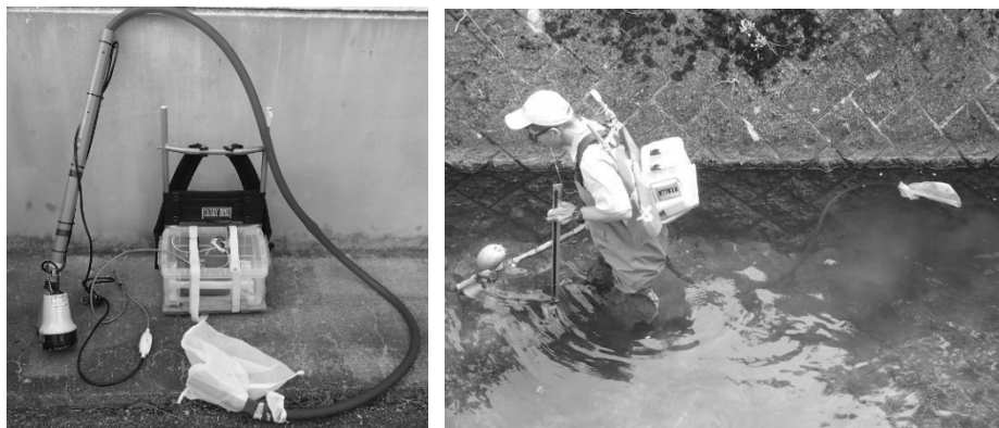
図 水中ポンプを使用した捕獲装置 (左：全体、右：使用状況)
