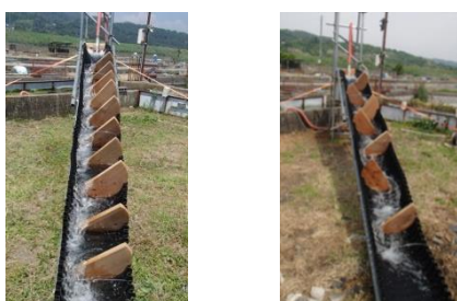
図1 作製した簡易魚道 (左：隔壁片側 右：隔壁交互)
