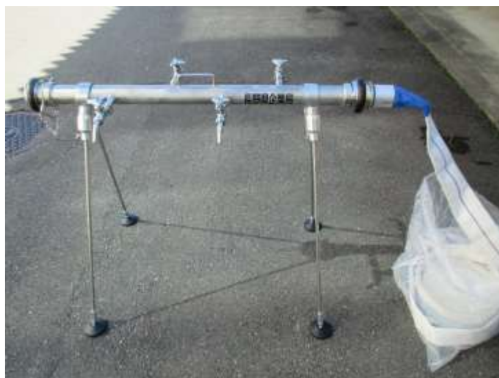
消防ホース(65A)を接続し市村の応急給水に活用します。
