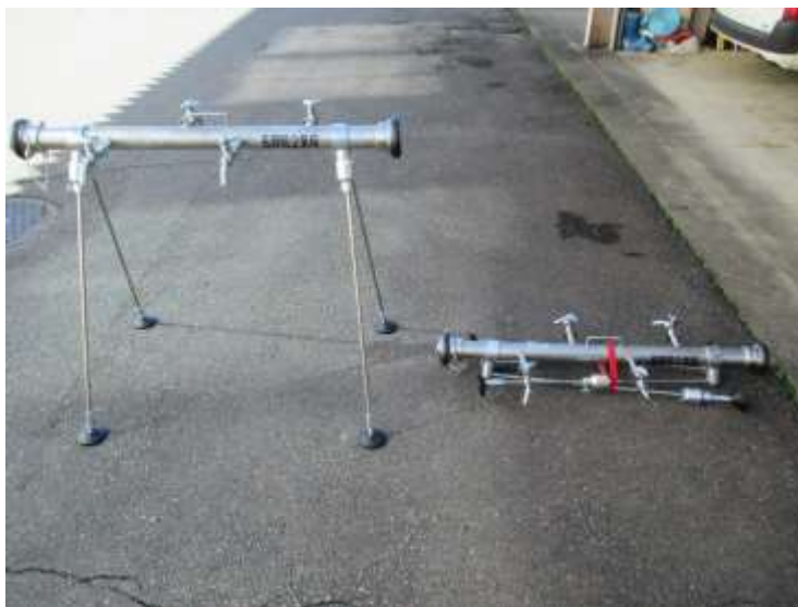
「組立式応急給水栓」左側が組立後、右側が組立前
