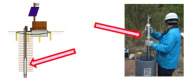
**傾斜計**…火山体内の流体の増圧等によって発生する地盤の僅かな傾きを精密に計測する器械です。ノイズ低減のため、火口周辺部では15m程度掘削して埋設する予定です。
