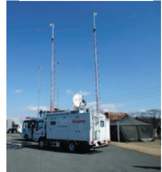
＜衛星エントランス 搭載移動基地局車＞
