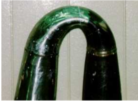
(180度曲げても破損しない溶接鋼管)
