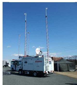
<衛星エントランス 搭載移動基地局車>
