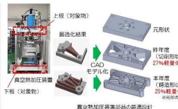
工業技術総合センターにおける共同研究事例：真空熱加圧装置の軽量化とコストダウンを目的として、CAEによるトポロジー(形状)最適化等を実施(2022年度：ミカドテクノス(株)との共同研究)
