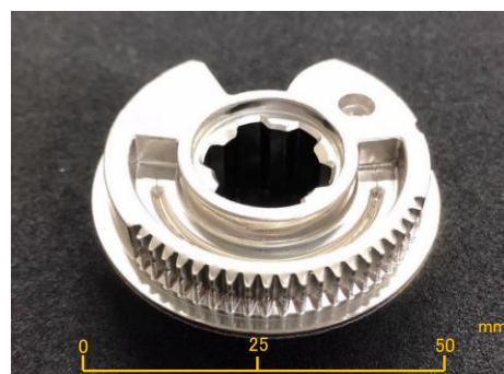
プレス加工のみによる三次元成形
