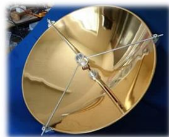
可視光通信実験局の反射鏡 (鏡面金めつき)
