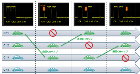
ノイズを検知・回避する高速な無線信号処理アルゴリズム
