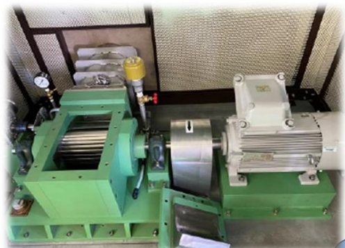
内部のクロスフロー水車
