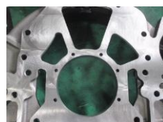
φ150mm切削工具で加工(段差あり)
