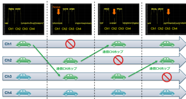
ノイズを検知・回避する高速な無線信号処理アルゴリズム
