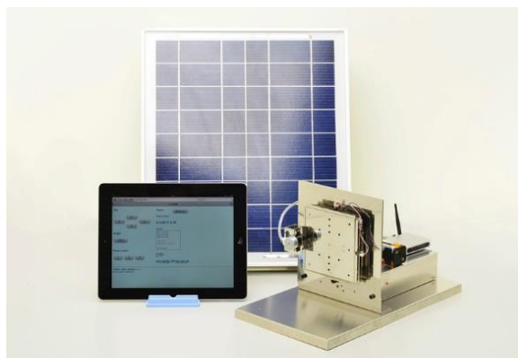
超精密钣金技術によるソーラー駆動式極薄X-Yステージ
