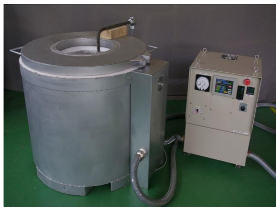
溶解炉本体と電源装置
