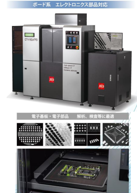
超高精度基板系CTスキャナ CTV190nH320/300 \mu FPD
