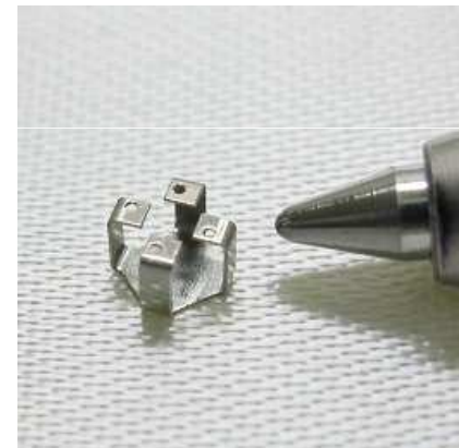
超精密微細钣金加工 曲げ \pm 0.03\text{mm}
