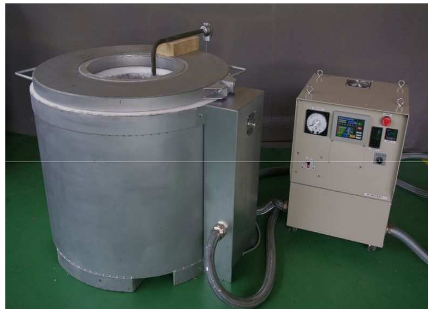
溶解炉本体と電源装置
