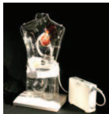
▲ 植込み型補助人工心臓 (株)サンメディカル技術研究所
