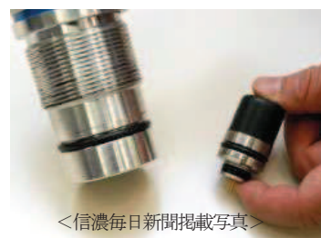
▲石油採掘用パイプの密封用部品
