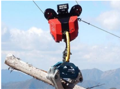
自動で集材作業を行う AI搭載架線式マシン
