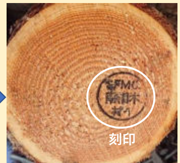
非認証材と区別（分別）するため全木材に刻印を打ちます。
