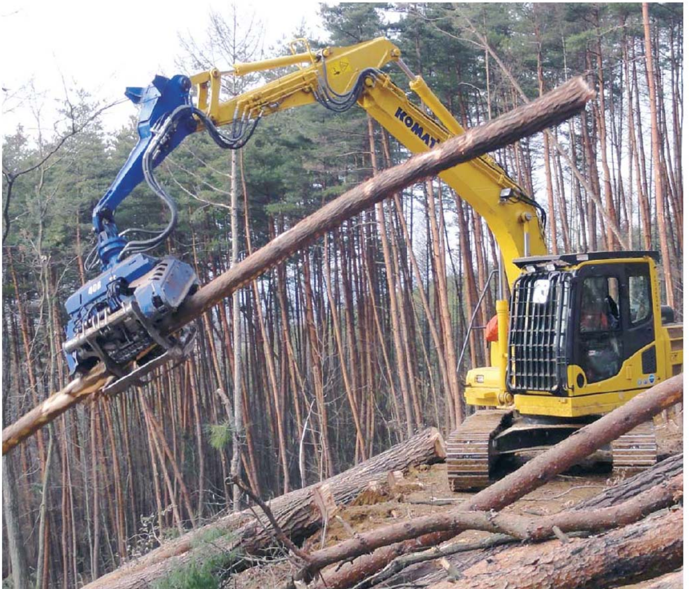
造材作業をする高性能林業機械「プロセッサ」(佐久市 片倉団地)
