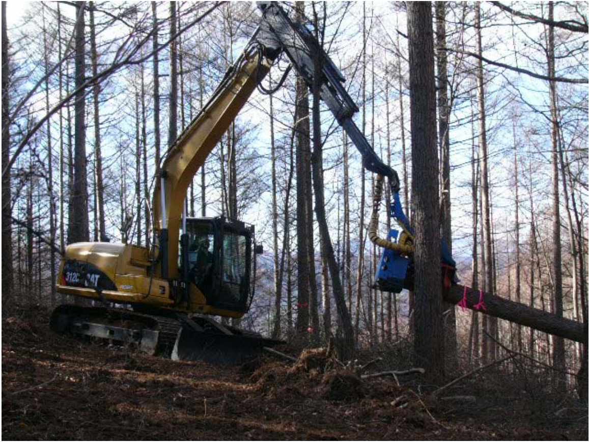
テレスコピックハーベスタ…アームが伸びて広い範囲の立木を掴み、伐採・造材することができます。
