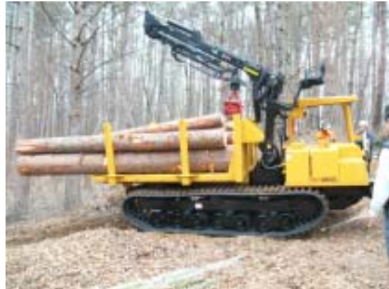
フォワーダ…間伐材を作業路を使って土場まで運びます。
