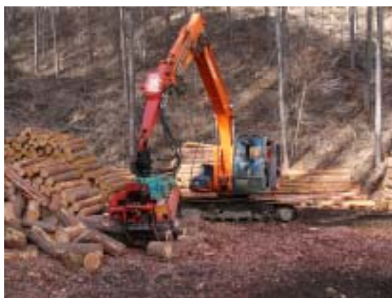
間伐材をプロセッサで、短く切断し積み重ねます。
