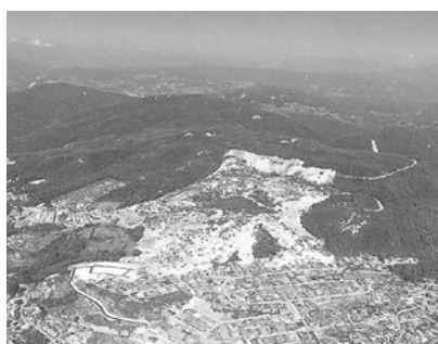
地附山地すべり被害状況
