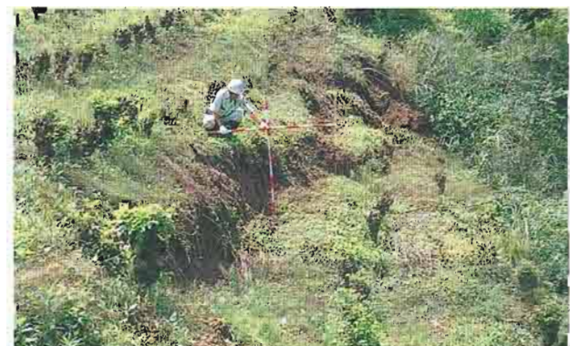
⑥主滑落崖の頭部(耕地の滑落)
