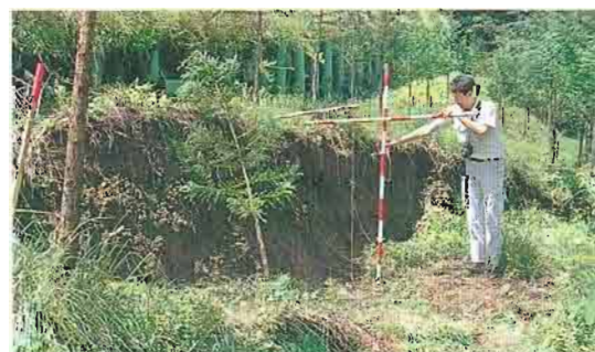
④主滑落崖の頭部(耕地の滑落)
