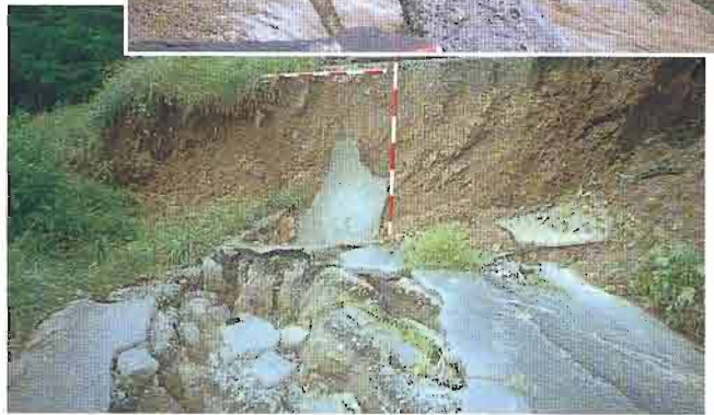
②ブロック側方に発生した滑落崖
