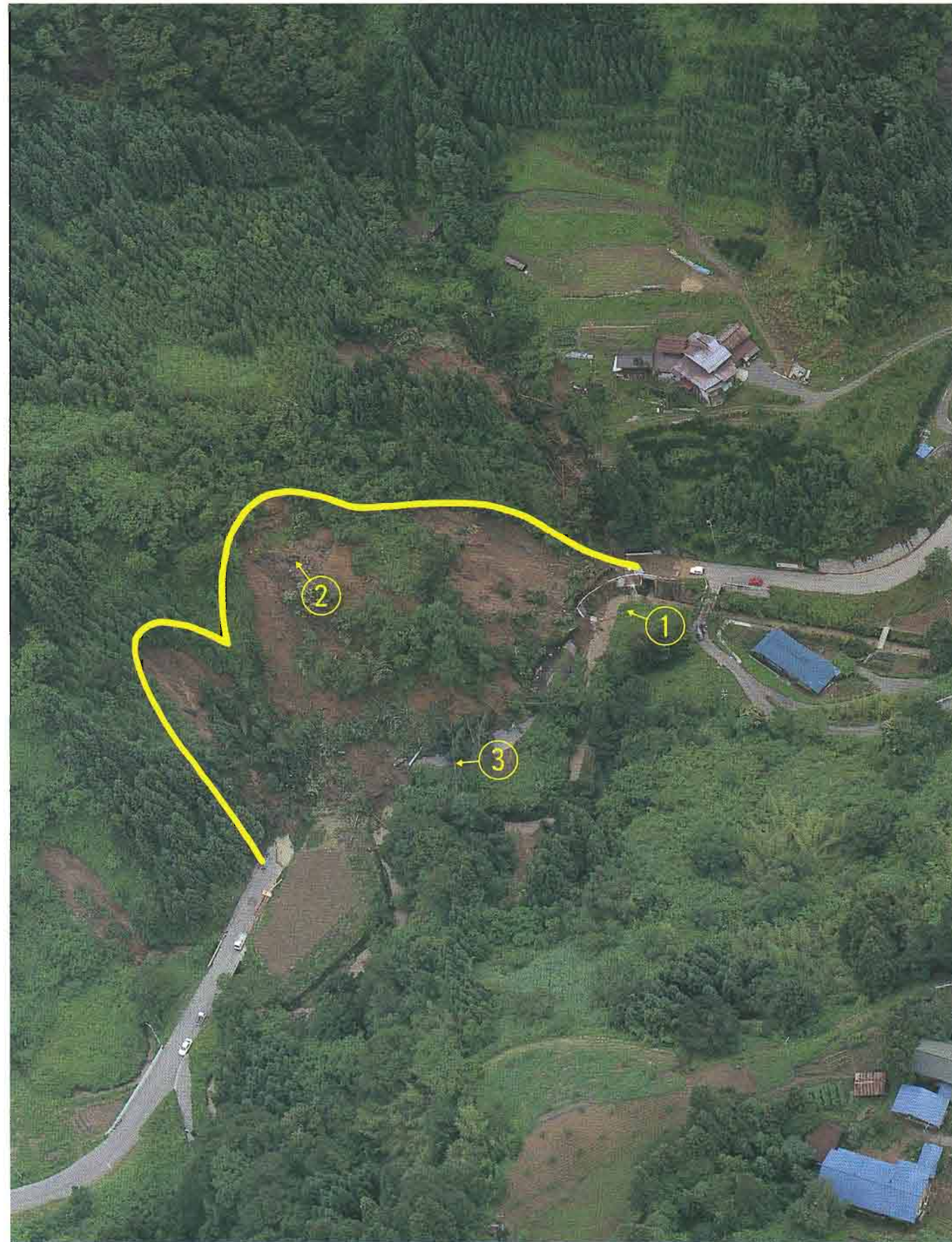
①地すべり土塊により法留擁壁が破壊
