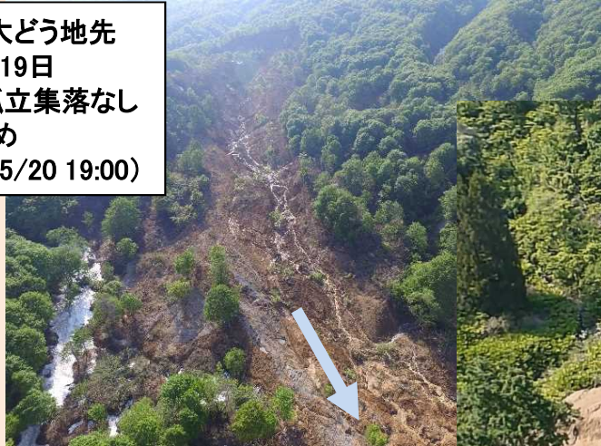
上流崩壊地状況 (H29.5.20撮影) 【崩壊規模】 幅: 約150m 長さ: 約500m 崩壊土砂量: 約60万m 3
