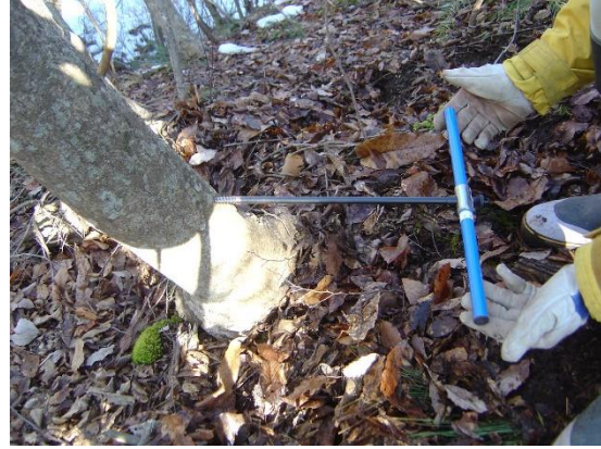
写真 4-17 成長錘によるサンプル採取
