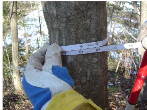
写真 4-13 直径巻尺による胸高直径の測定状況
