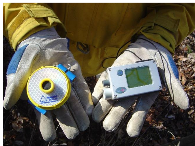
写真 4-15 超音波式樹高測定器、トランスポンダー（左）とバーテックスⅣ（右）
