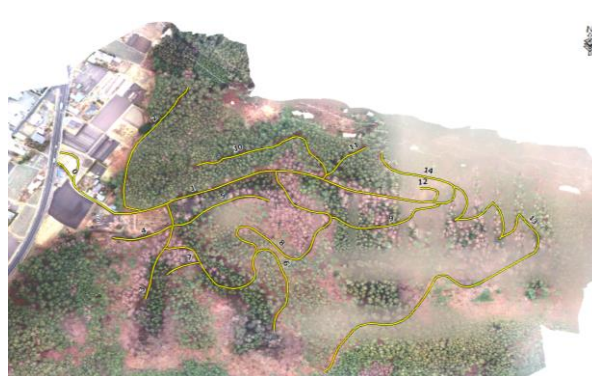
ドローンオルソ画像からの路網計測 路網配置位置や路網延長を計測できる
