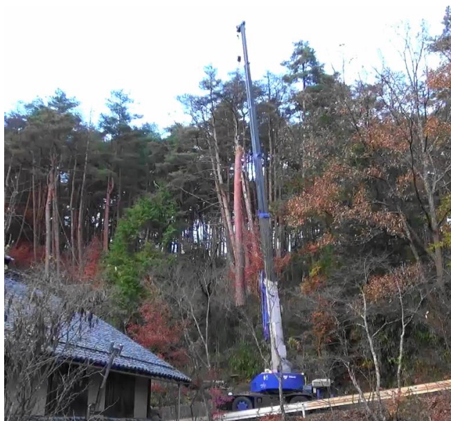
写真 2-30 クレーンによるアカマツの特殊伐採 (長野県森林づくり県民税事業)
