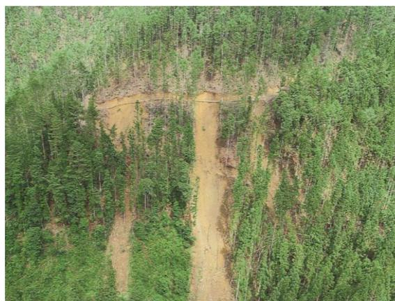
写真 1-2 傾斜 35 度以上の山地の森林作業道作設に起因する崩壊
