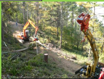
スイングヤーダ木寄せに よる架線システム
