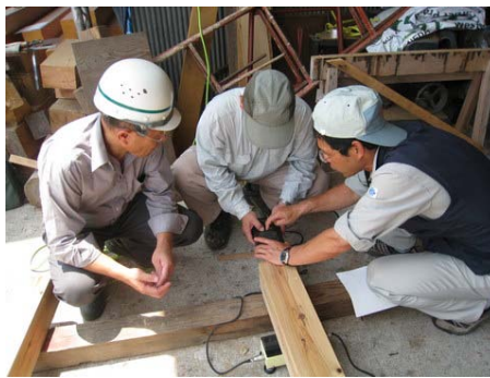
認証材の検査の状況
