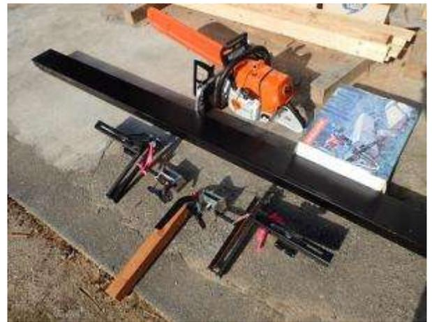
間伐材の活用のため導入された移動式製材機
