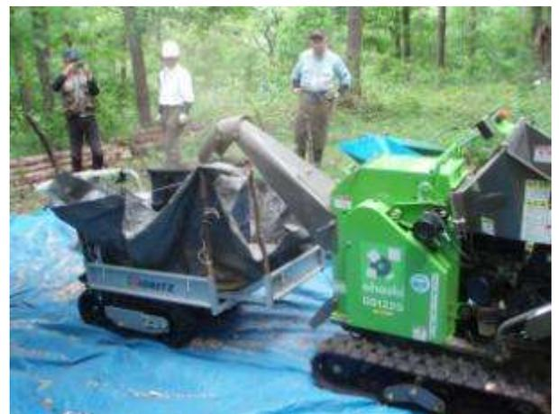
移動式チップパーによる散策路の整備
