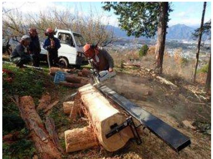
移動式製材機による板材生産状況
