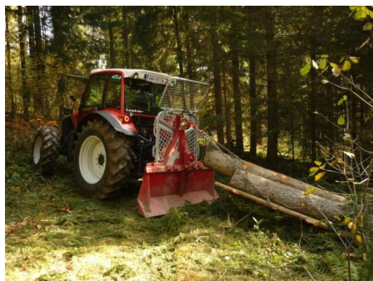
農業用トラクタを利用した集材。120馬力
