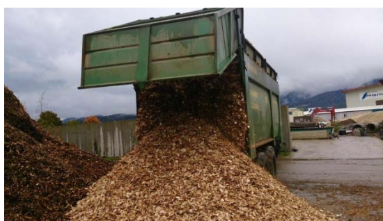
チップの搬入(コンテナの奥から押し出す仕組み)
