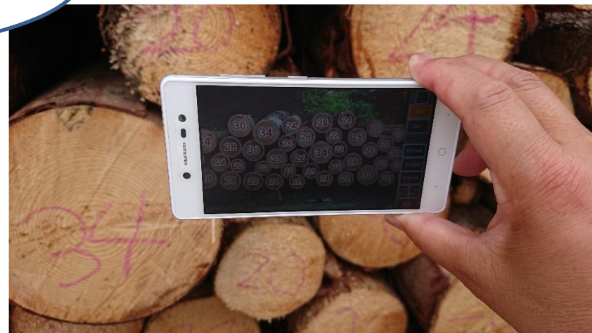
タブレットで木材を撮影し、材積を自動で算出
