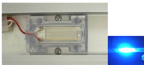
写真 3-1 青色 LED(ピーク波長 450nm) パナソニック(株)ライティング社製(MS-M260BGP)
