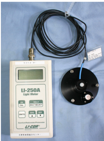
写真 3-4 測定機器 : ライカ社製ライトメーターL1-250A
