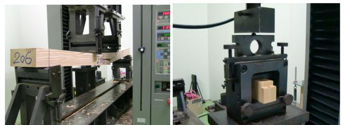
写真-3 曲げ試験の様子
