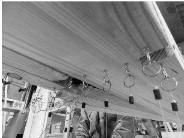
No. 1 : 曲げ破壊（下面）
