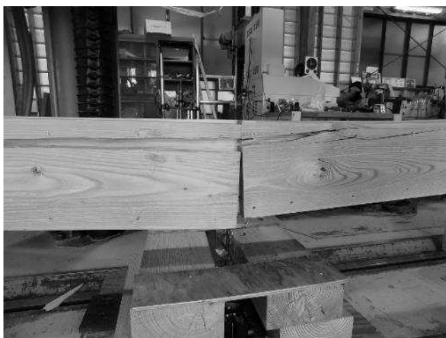
No. 2 : 曲げ破壊および最外層釘接合部のせん断破壊
