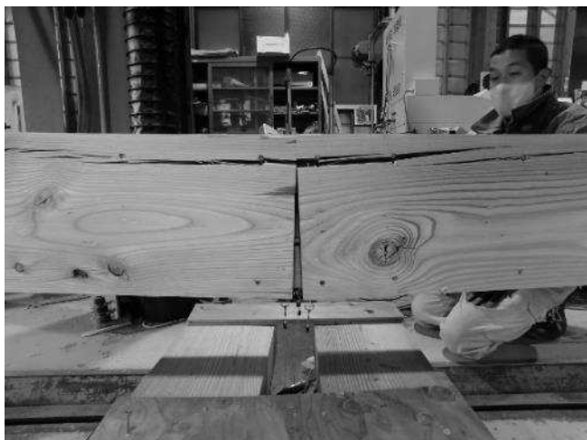
No. 1 : 曲げ破壊および最外層釘接合部のせん断破壊
