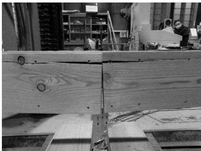
No. 3 : 曲げ破壊および最外層釘接合部のせん断破壊
