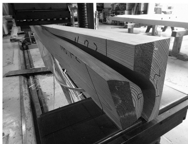
写真 2-7 目まわりによる破壊
