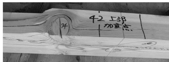
写真 3-10 荷重点外の狭い面の節 (例外)
